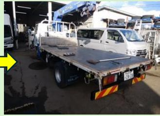
ポディー根太組、床板交換等、重量寸法変動時は 構造変更車検も
